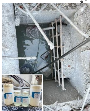
รูปที่ 3.43 การเก็บตัวอย่างคุณภาพน้ำทิ้ง บริเวณคุณภาพน้ำทิ้งจากถังบำบัดน้ำเสียสำเร็จรูป (จุดที่ 1)
