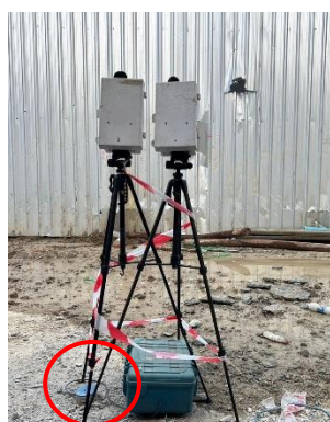
รูปที่ 3.40 การตรวจวัดความสั่นสะเทือน ภายในพื้นที่โครงการ บริเวณด้านทิศตะวันออกก่อนแนวกำแพงกัน
