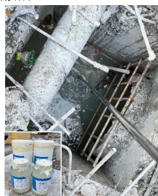
รูปที่ 3.44 การเก็บตัวอย่างคุณภาพน้ำทิ้ง บริเวณคุณภาพน้ำทิ้งจากถังบำบัดน้ำเสียสำเร็จรูป (จุดที่ 2)
