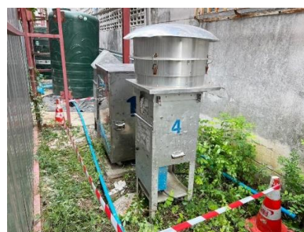
รูปที่ 3.3 การเก็บตัวอย่างคุณภาพอากาศในบรรยากาศภายนอกพื้นที่โครงการบริเวณพื้นที่ว่างด้านทิศตะวันออก
